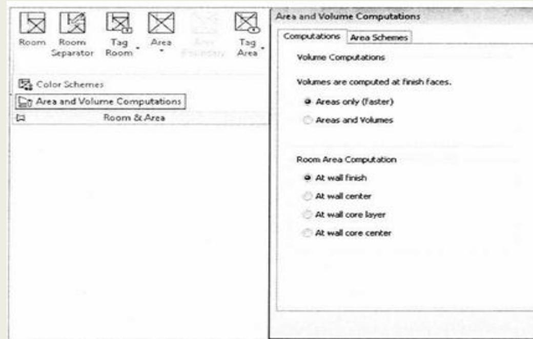
SLIKA 8.1 Podešavanje izračunavanja površine i zapreme
